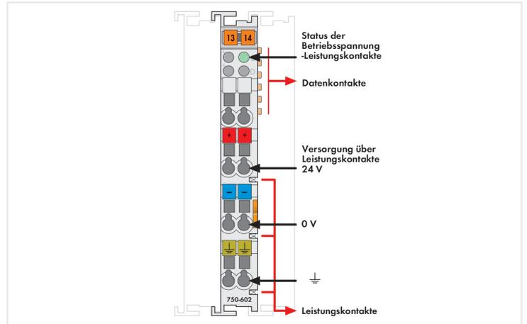
Este módulo de alimentación dota a los acopladores de comunicaciones y algunos módulos de E/S que lo requieren del correspondiente potencial de alimentación.
