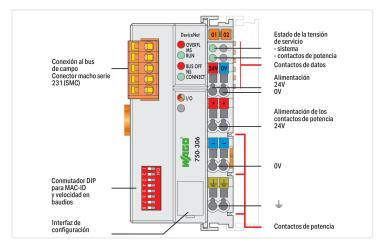
El acoplador de bus de campo permite la conexión de los módulos WAGO-I/O-SYSTEM como esclavos al bus de campo DeviceNet.
