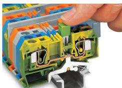
Las bornas de tierra solo se pueden puentear con bornas de paso en una dirección (por la parte posterior de la borna) utilizando puentes contiguos. WAGO recomienda usar puentes contiguos verdes-amarillos además del marcaje necesario de estas bornas.
