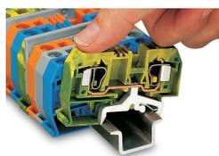
Al conectar una borna de tierra al carril DIN se establece automáticamente una conexión eléctrica directa con el carril.
