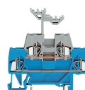
Las bornas de doble piso alojan dos circuitos de distintos potenciales en dos pisos; la codificación por colores de cada piso ayuda a diferenciar los circuitos (serie 280). El piso inferior es más ancho que el superior para facilitar el cableado.
