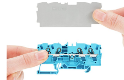
Placa separadora para aplicaciones Ex e/Ex i En la borna situada directamente detrás de la placa separadora de Ex e/Ex i se debe fijar una placa final.
