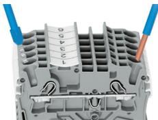
Conexión enchufable de conductores rígidos y con puntera
