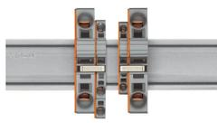
Reducción mediante peine de puentes: El punteado en el lado abierto de la borna con placa final permite puentear con dos tamaños de sección con conductores de 16 mm<sup>2</sup> y 10 mm<sup>2</sup> y con solo tamaño de sección con conductores de 6/4/2,5 mm<sup>2</sup>. Un ejemplo: de 16 mm<sup>2</sup> a 6 mm<sup>2</sup> (ver ilustración arriba) o de 10 mm<sup>2</sup> a 4 mm<sup>2</sup>.
