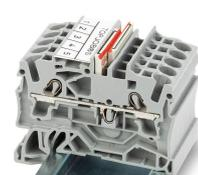
Monte los puentes escalonados con las rayas rojas mirando hacia dentro. Inserte el puente escalonado y presione hasta el fondo.
